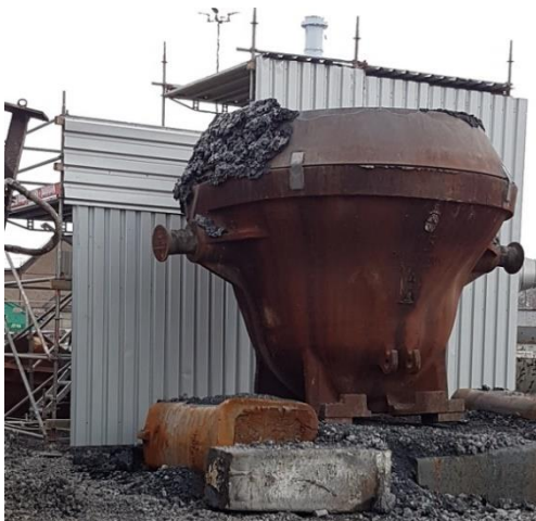
Abb. 7: Bühne am Schlackenplatz mit mobiler Wassergranulation.
