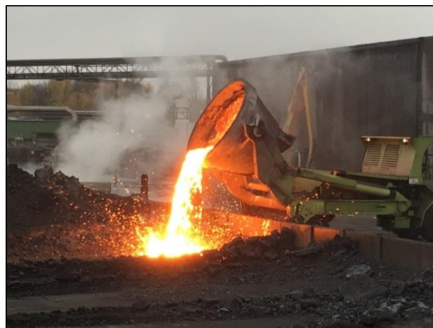
Abb. 5: Abguss der reduzierten EOS im flüssigen Zustand.
