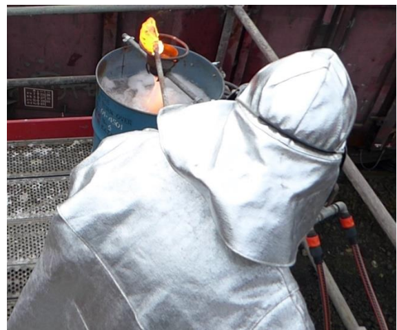
Abb. 7: Bühne am Schlackenplatz mit mobiler Wassergranulation.
