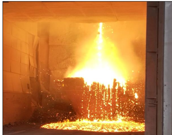
Abb. 3: Reduktionsreaktion während des Abstichs der flüssigen EOS.
